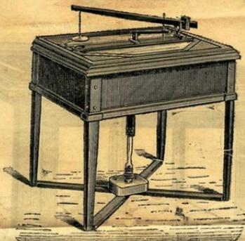
Vue d'une couveuse à air chaud avec le nouveau régulateur de précision (s'appliquant à partir de 75 œufs)
